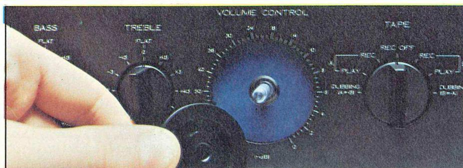
La realizzazione di tutti i particolari meccanici è di livello molto superiore alla media. Le varie superfici della manopola del volume, per esempio, tutta in metallo pieno, sono rifinite in maniera diversa l'una dall'altra.
